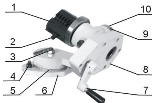
Оборудование для заточки сверл используется для заточки сверл правого вращения диаметрами 5 – 20 мм. Преимуществом данного оборудования являются крепежные зажимы, в которых можно закрепить сверла любого размера. После выбора сверла и закрепления его в зажимах, инструмент прочно закрепляется болтом (2). Ослабьте болт (3) и при помощи шкалы 5 установите требуемый угол сверла при вершине резьбы (этот угол определяется в соответствии с материалом – сталь, чугун, цветной металл, жесть).
