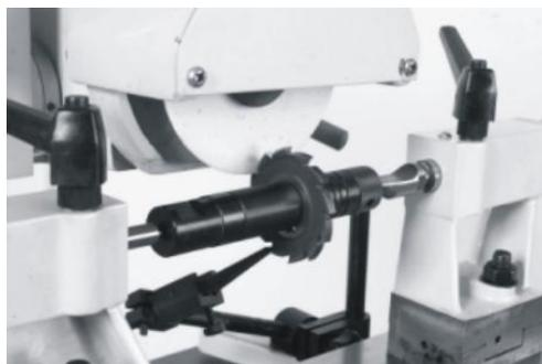
При шлифовании между центрами (фото 1) в первую очередь необходимо прочно закрепить опоры на подвижном столе. Следите, чтобы выбор упорных центров был верным. Если необходимо обработать материал малых размеров или инструмент до края у центрального отверстия необходимо использовать упорный центр (с пережимом).
