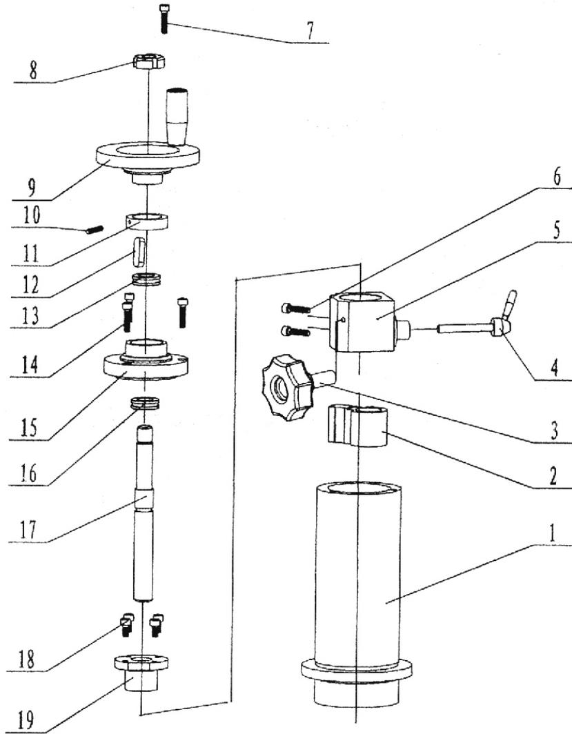
Схема поворотного устройства с электроприводом
