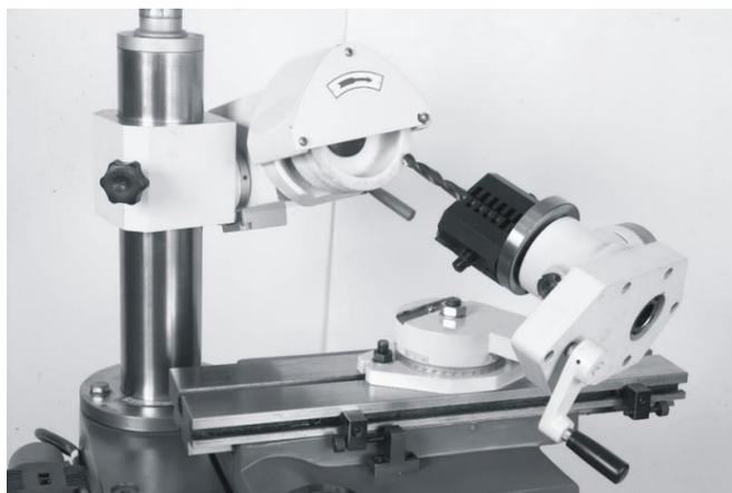
и наклоном сверла. Установите инструмент таким образом, чтобы при максимальном выносе головы достигалась конечная фаза шлифования.
