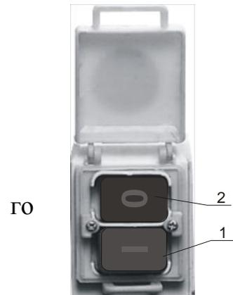
Станок запускается зеленой кнопкой «I», отключается красной кнопкой «0». Кнопка «Стоп» служит для экстренного отключения оборудования.
