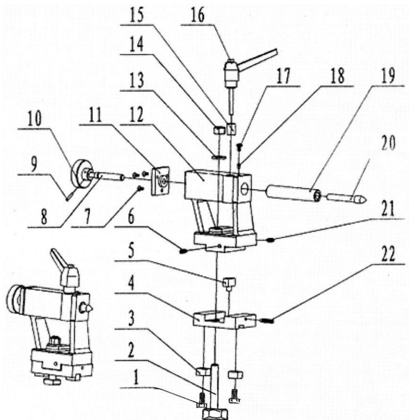
Схема электрического привода вращения заточного круга
