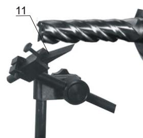
После обработки одной детали при помощи рычага продольного перемещения отодвиньте инструмент от заточного круга и опоры. Поверните инструмент на одну режущую кромку и повторите процесс по винтовой линии второй режущей кромки. В случае неровностей на затачиваемой части инструмента, процесс можно повторить заново.
